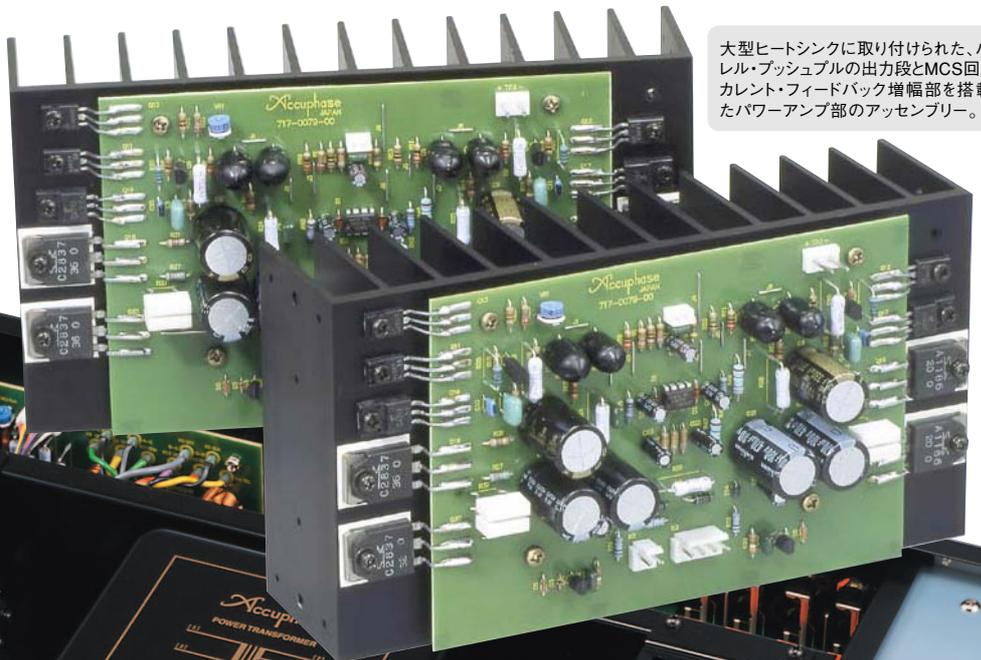
大型ヒートシンクに取り付けられた、パラボラ・プッシュプル出力段とMCS回路、カレント・フィードバック増幅部を搭載したパワーアンプ部のアッセンブリ。
