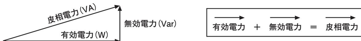
このようにオーディオ機器は電源から見た負荷として抵抗成分だけでなく、コンデンサーやコイルの成分を含むため、PS-550等の電源は有効電力と無効電力を合わせた大きな皮相電力を担うことになります。
