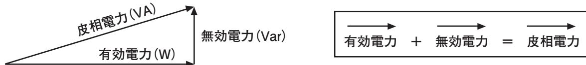
このようにオーディオ機器は電源から見た負荷として抵抗成分だけでなく、コンデンサーやコイルの成分を含むため、PS-1250等の電源は有効電力と無効電力を合わせた大きな皮相電力を担うことになります。
