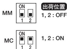
**MM: 高出力電圧のMM型カートリッジ**
