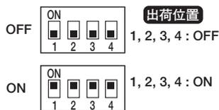
このフィルターは、超低域25Hz以下を-12dB/octaveという急峻な特性でカットし、超低域ノイズが可聴帯域内へ悪影響をおよぼすことを防ぎます。レコードに大きな反りがあったり、超低域の振動によりウーファーがゆれたりするときに変有効です。
