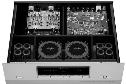
[写真14] DC-950の内部。後方右はデジタル回路基板、左はアナログ回路基板群でシールドカバー付き。手前は電源回路群
