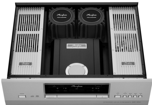
[写真13] DP-950の内部。中央手前にドライブメカ、後方に電源トランス群、左側は電源回路で右は制御系と信号系の基板
