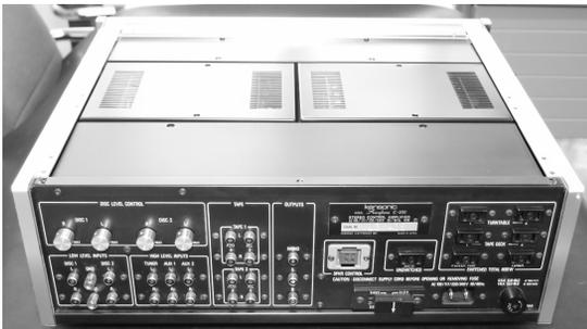
[写真14] 天板を外したC-200の後ろ姿。各ブロックはシールドケースで覆われている。リアパネルの四角い4P端子は、2組のスピーカーをC-200側で切り換えるリレーボックス接続用
