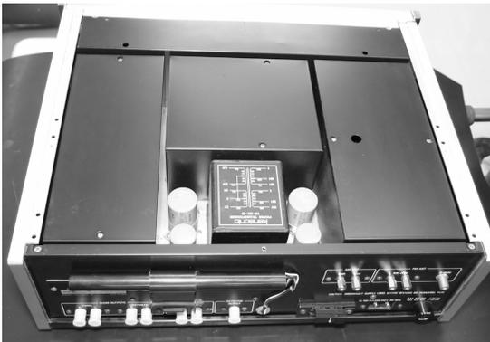
【写真10】 天板を外したT-100の後ろ姿。各ブロックはシールドケースで覆われている。リアパネルのAMバーアンテナは可変式で、使用時は受信状態の良い角度に調整する
