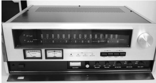
【写真9】 サブパネルカバーをあけたT-100。使用頻度の低いツマミ類とマルチパスメーターはサブパネルに付いている
