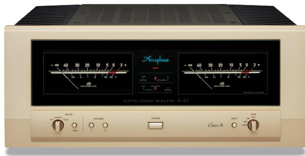
純A級パワーアンプの醍醐味——出力の有無にかかわらず、常に定格最大出力時の電力を供給する純A級動作。この贅沢な動作を実現する強力な電源と出力段が聴かせる世界はオーディオの醍醐味であり、理想を追求したパワーアンプの頂点です。A-47は純A級パワーアンプを極限まで磨き上げてA-46の内容を一新、最新のインスツルメンテーション・アンプ方式を採用して信号経路をバランス伝送化、カレント・フィードバック増幅回路を搭載して、SN比、ひずみ率など諸特性を改善しています。出力保護回路に「MOSFETスイッチ」を採用し、出力回路の低インピーダンス化と信頼性向上を図り、ダンピング・ファクター：600を実現しました。さらに強力電源部と「パワー-MOSFET」6パラレル・プッシュアップ構成により1Ωの超低インピーダンス負荷で360W/chの出力が可能で、さらにブリッジ接続により720W/2Ω (音楽信号) の大出力モノフォニック・アンプにグレードアップすることができます。
