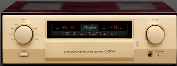
C-3900は創立50周年を記念して開発した最上位のプリアンプです。一般的なプリアンプは、入力信号を抵抗体で減衰させた後にアンプで増幅するためノイズが増加してしまいます。一方アクフェーズの「AAVA」は様々な増幅度の[V-I(電圧・電流)変換回路]の組み合わせでダイレクトに音量を調整するため、インピーダンスと周波数特性が変わらず音質の変化がありません。また、ボリューム位置によるノイズレベルの変化が極めて少なく、実用的な音量レベルでのSN比にも優れています。C-3900では「AAVA」の2回路平衡駆動である「Balanced AAVA」を、さらに2回路並列駆動させた「Dual Balanced AAVA」を搭載することで、ノイズレベルは従来機種に比べて約30%減少しました。「ボリューム・センサー機構」は、滑らかな動作、重厚な操作感、緻密な位置検出を実現しています。C-3900は心が震えるほどの感動を味わえる最高峰のプリアンプです。なおステレオ・フォノ・アンプC-47を接続すれば、アナログ・レコードの演奏もお楽しみいただけます。
