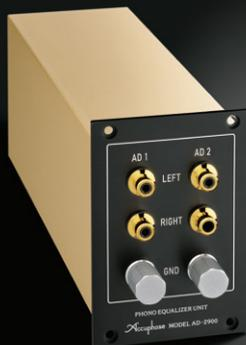
AD-2900は、C-2900のリア側に挿入するフォノ・イコライザー・ユニットです。左右独立構成の低誘電率・低損失「ガラス布フッ素樹脂基板」に、MC/MMそれぞれ専用の差動増幅回路と共通の差動型イコライザー回路を搭載し、高いノイズ性能と高精度なRIAA特性を実現しています。また、入力端子を2系統備え、2本のトーン・アームを本体のインプット・セレクターで選択できます。さらに、本体のフロント・パネルから、ADゲインやMC入力インピーダンスの切り替えも可能です。
