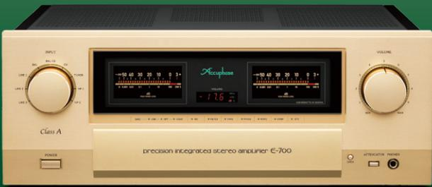
E-700は「フル・バランス構成」の純A級プリメイン・アンプです。ボリューム・コントロール回路に「Balanced AAVA」を採用し、演奏の瑞々しさを損なわずに音量を調整します。パワー・アンプ部にはバランス回路「インスツルメンテーション・アンプ」と「パワー・MOSFET」4パラレル・プッシュプルA級動作を採用し、リニアな出力(35W/8Ω、70W/4Ω、140W/2Ω)と、1Ω負荷での160W(音楽信号)のパワーを実現しています。また「バランス・リモート・センシング」や「MOSFETスイッチ」の採用により、ダンピング・ファクターは1000を誇ります。理想の追求から誕生したE-700は、あらゆるスピーカーのポテンシャルを引き出し、音楽性豊かなサウンドを奏でます。
