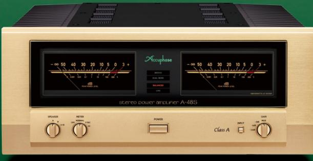
A-48Sは上級機で培った最先端の技術を搭載することで、性能と音質を大幅に向上させたA級パワーアンプです。大型トイダルトランスと大容量68000μFのフィルター・コンデンサーで構成した電源部や、パワー・MOSFET 6パラレル・プッシュプル出力段の最適化により、従来モデルを11%上回る、50W/8Ω、100W/4Ω、200W/2Ω、400W/1Ωの出力とリニアな定電圧駆動を実現しました。また、最新の低ノイズ化技術を惜しみなく投入することで、従来モデルよりノイズ・レベルを6%改善しています。さらに、ダンピング・ファクターは1000を達成し、大型スピーカーも悠々とドライブします。加えて、ブリッジ接続により800W/2Ωの大出力モノフォニック・アンプへのアップグレードも可能です。豊かな音楽性を獲得したA-48Sは、時間が経つのも忘れるほど心奪われるパワーアンプです。
