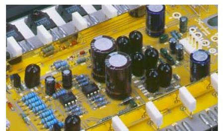
本機のMCS回路は、入力信号を増幅するユニットを3回路並列接続することで低雑音化を図り、SN比、ひずみ率など諸特性が大幅に向上、一段と優れた音質を実現しました。
