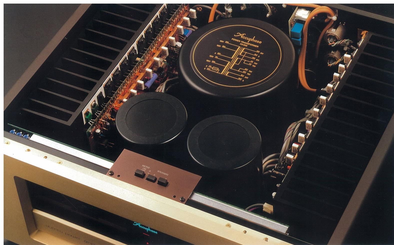
方法です。本機には切替スイッチが装備され、1,100W/4Ω、840W/8Ωの量感豊かなパワーを供給することができます。この方法でモノフォニック・アンプ化することにより、パワーアンプをもう一台追加するだけで大幅な音質改善ができ、最も合理的なグレードアップの方法と云えましょう。
