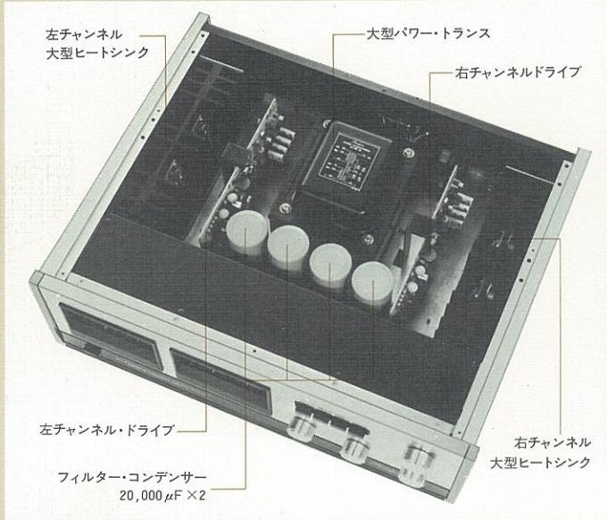
20,000μF×2のフィルター・コンデンサーを基調に、4Ω負荷の出力280W連続でもびくともしない余裕十分な電源部を構成しています。
