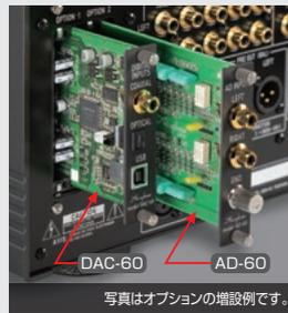
3種類のオプション・ボード(DAC-60、AD-60、LINE-10)から、2枚のオプション・ボードを挿入可能なスロットを装備しています。
