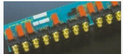
金メッキ入・出力端子に直結した、完全密閉構造リレー群
