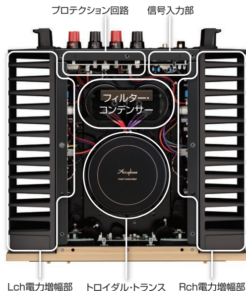
Lch電力増幅部 トロイダル・トランス Rch電力増幅部
