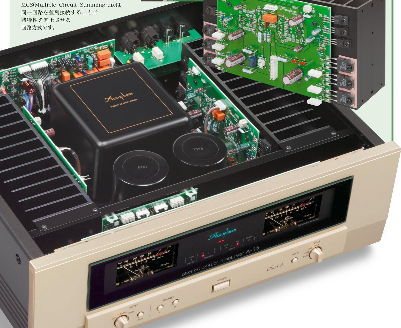
■A-36を2台使用して、ブリッジ接続やバイアンプ接続にアップグレードすることができます。■入力信号は2台ともLEFT端子 (BALANCED又はLINE) へ接続します。
