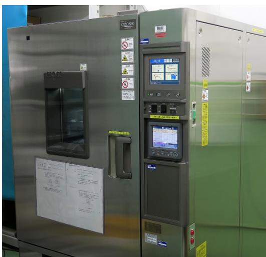
温度・湿度試験を行う恒温槽
