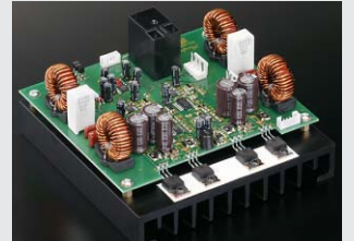
パワーアンプ・ユニット(2チャンネル)
