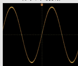
写真⑥PS-1210の出力波形(ひずみ率:約0.2%)
