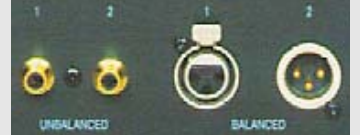
アンバランス入力端子とバランス入力コネクター (“2”端子はブリッジ接続時の送り出し用)
