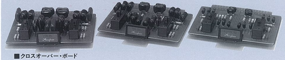
■サブパネルを開いたフロント・パネル クロスオーバー・ボードを差し替えることにより簡単にクロスオーバー周波数の変更ができる。
