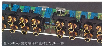
金メッキ入・出力端子に直結したリレー群
