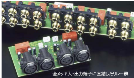
金メッキ入・出力端子に直結したリレー群
