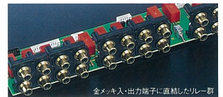
全メッキ入・出力端子に直結したリレー群
