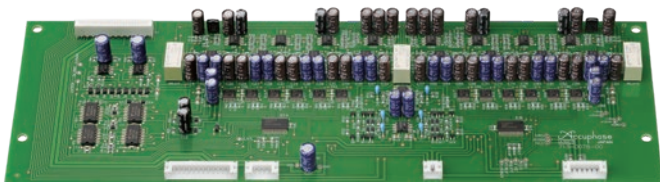
ノイズが低減した『AAVA』方式ボリューム・コントロール・アッセンブリー
