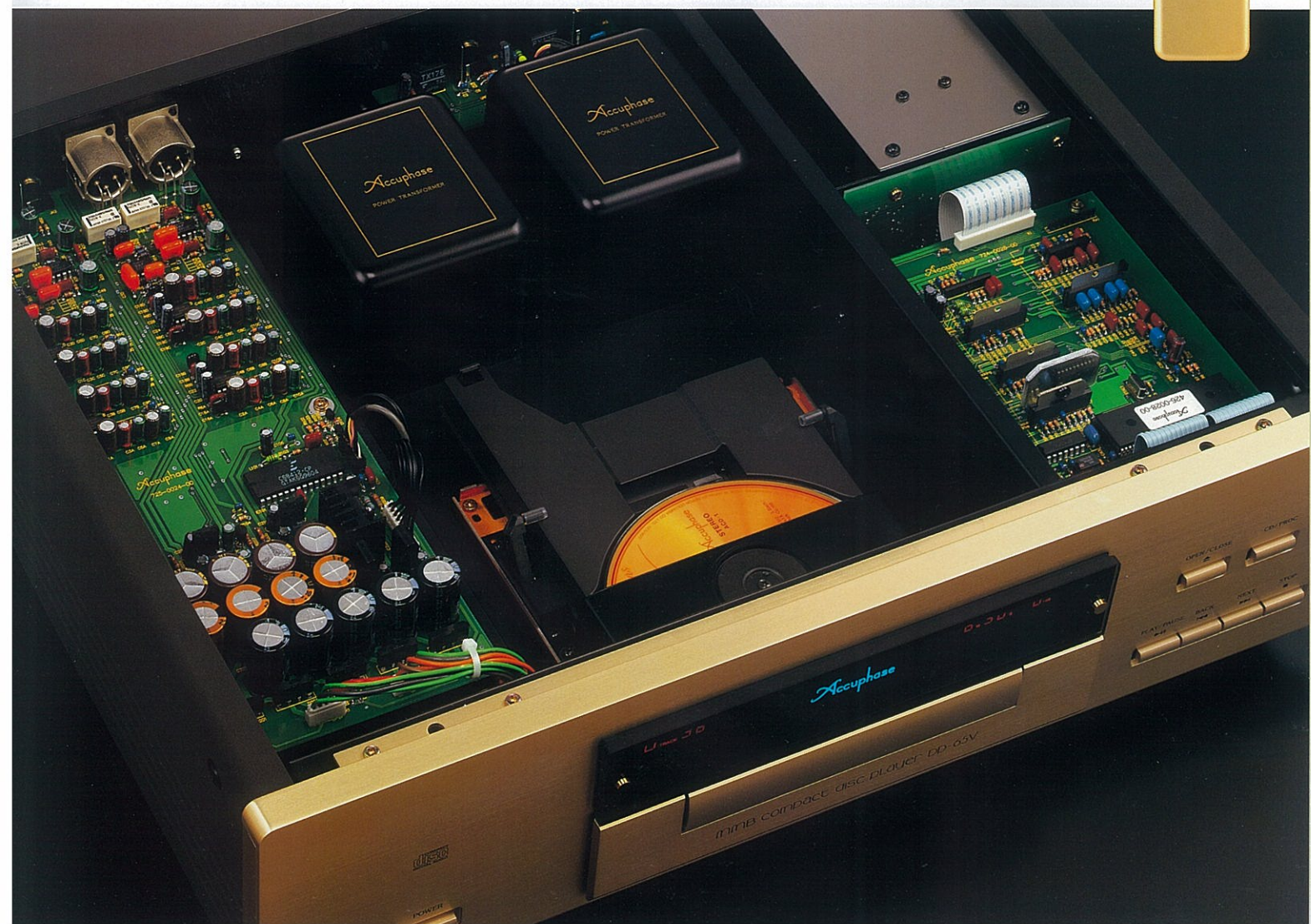
■デジタル関係のAss'y CDトランスポートのデジタルサーボ・コントロールIC、アクチュエーターのバランス駆動回路などを搭載したアッセンブリー。
