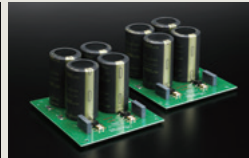
合計80,000µFの フィルタ・コンデンサー
