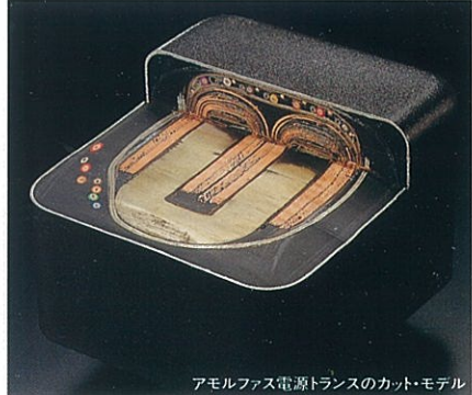
アモルファス電源トランスのカット・モデル
