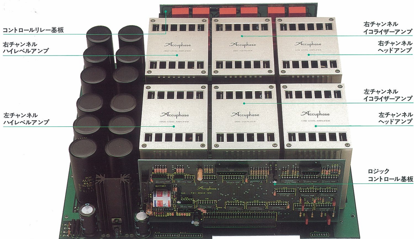
● マザーボード上のユニットアンプとロジック・コントロール・ボード
