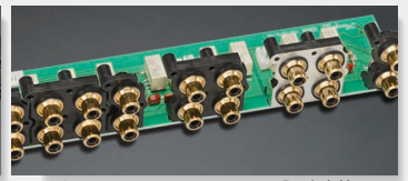
ロジック・リレーコントロールとライン入・出力端子
