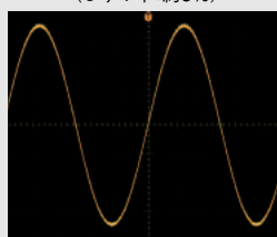
写真⑥PS-1210の出力波形(ひずみ率:約0.2%)
