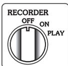
21 RECORDER端子にレコーダーを接続して録音/再生を切り替えるスイッチです。録音/再生の操作は13ページ参照
