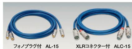
●型式 2芯シールド構造 ●中心導体部 [無酸素銅線+銀メッキ軟銅線] ●外被絶縁体 PVC ブルー、φ8.0mm ●絶縁体 ポリエチレン+発泡ポリエチレン ●ループ間総直流抵抗 33mΩ/m ●電極間静電容量 170pF/m ●絶縁抵抗 40MΩ/km
