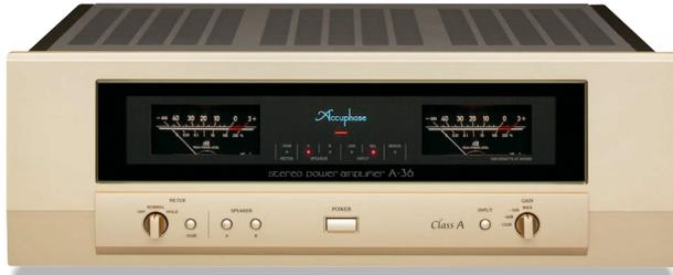
磨き上げた結晶・・・純A級ステレオ・パワーアンプの基本モデル——A-36は、A-200やA-70などの卓越した設計テクノロジーを受け継ぎ、音に対するこだわりと魅力溢れる音質を追求して、純A級ステレオ・パワーアンプとして細部に至るまで念入り「磨き上げた」充実のベーシック・モデルです。出力素子に「パワー-MOSFET」をチャンネル当たり3パラレル・プッシュプル構成、インスルメンテーション・アンプ方式を採用して信号経路をバランス伝送化、「MCS+」回路、カレント・フィードバック増幅回路を搭載して、より一層性能・音質を向上させました。強力な電源部により、1Ωの低インピーダンス負荷で150W（音楽信号）の余裕ある出力を実現、さらにブリッジ接続にして、より大出力モノフォニック・パワーアンプにアップグレードすることができます。また、出力回路にはリレーの代わりに機械的接点がなく長期信頼性に優れた「MOSFETスイッチ」を使用するなど、最高グレードの素材や回路を巧みに駆使することにより、徹底的に低インピーダンス化し、DF（ダンピングファクター）:400を実現しました。
