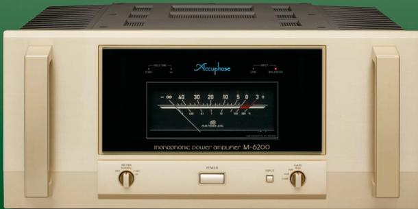
M-6200は、パワーアンプの理想形を追求し、歴代最高の性能と魅力溢れる音を目指した、本格的「モノフォニック・パワーアンプ」です。ディスクリート構成の超低雑音インスルメンテーション・アンプにより増幅部をフルバランス伝送化、さらに「MCS+回路」とカレント・フィードバック増幅回路を搭載してGAIN MAX時127dB、GAIN -12dB時133dBのSN比を実現。2台のパワーアンプユニットを並列動作させることにより、極めて低い出力インピーダンスのパワーアンプを実現し、超低インピーダンスまで定電圧駆動を可能にしています。強力電源部と「ハイパワー・トランジスター」16パラレル・プッシュプル構成で、1Ωの超低インピーダンス負荷時1,200W（音楽信号）を達成。出力回路を低インピーダンス化し、ダンピング・ファクター1,000を実現しています。モノフォニック・パワーアンプとしての堂々たる風格と量感を備え、音質面では迫力あるダイナミズムと微細な表現能力の再現を徹底的に追求、音楽感動を生々しく伝えてくれます。
