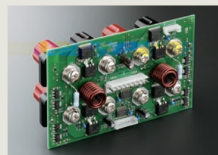
MOSFETスイッチを搭載した プロテクション回路
