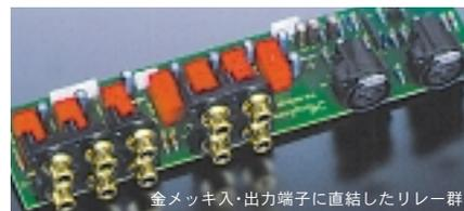
**音質重視の加算型アクティブ・フィルター方式トーン・コントロール**
