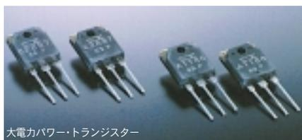
ティ、スイッチング等の諸特性に優れた、マルチエミッタ型大電力オーディオ用パワートランジスターを採用しました。この素子を平行・プッシュプルで構成(第1図)し、低インピーダンス化を図りました。そしてこれらの素子を、大型のヒートシンク上に取り付け、効率的な放熱処理をしています。このように十分な余裕をもつ設計により、チャンネル当たり115W/4Ω、105W/6Ω、90W/8Ωのハイクオリティなパワーを実現しました。
