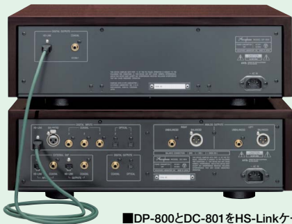
■ DP-800とDC-801をHS-Linkケーブルで接続
