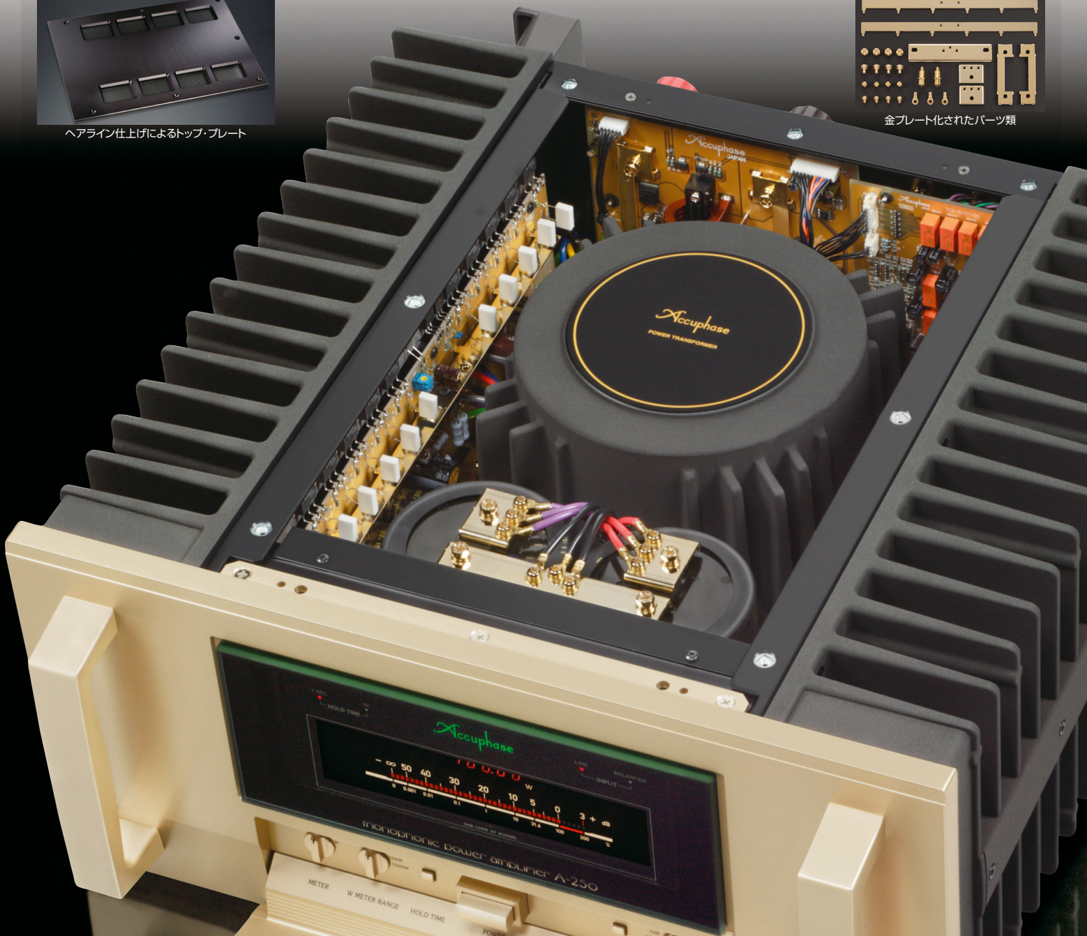
真鍮無垢材を切削加工して金プレート化した大型スピーカー端子 MOSFETスイッチ 極太エッジワイス・コイル プロテクション回路アセンブリ 『OPERATION』スイッチ
