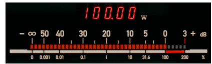
デジタル・パワーメーターとバーグラフ・メーター
