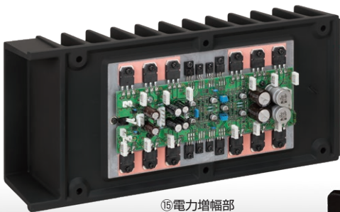
⑮電力増幅部
